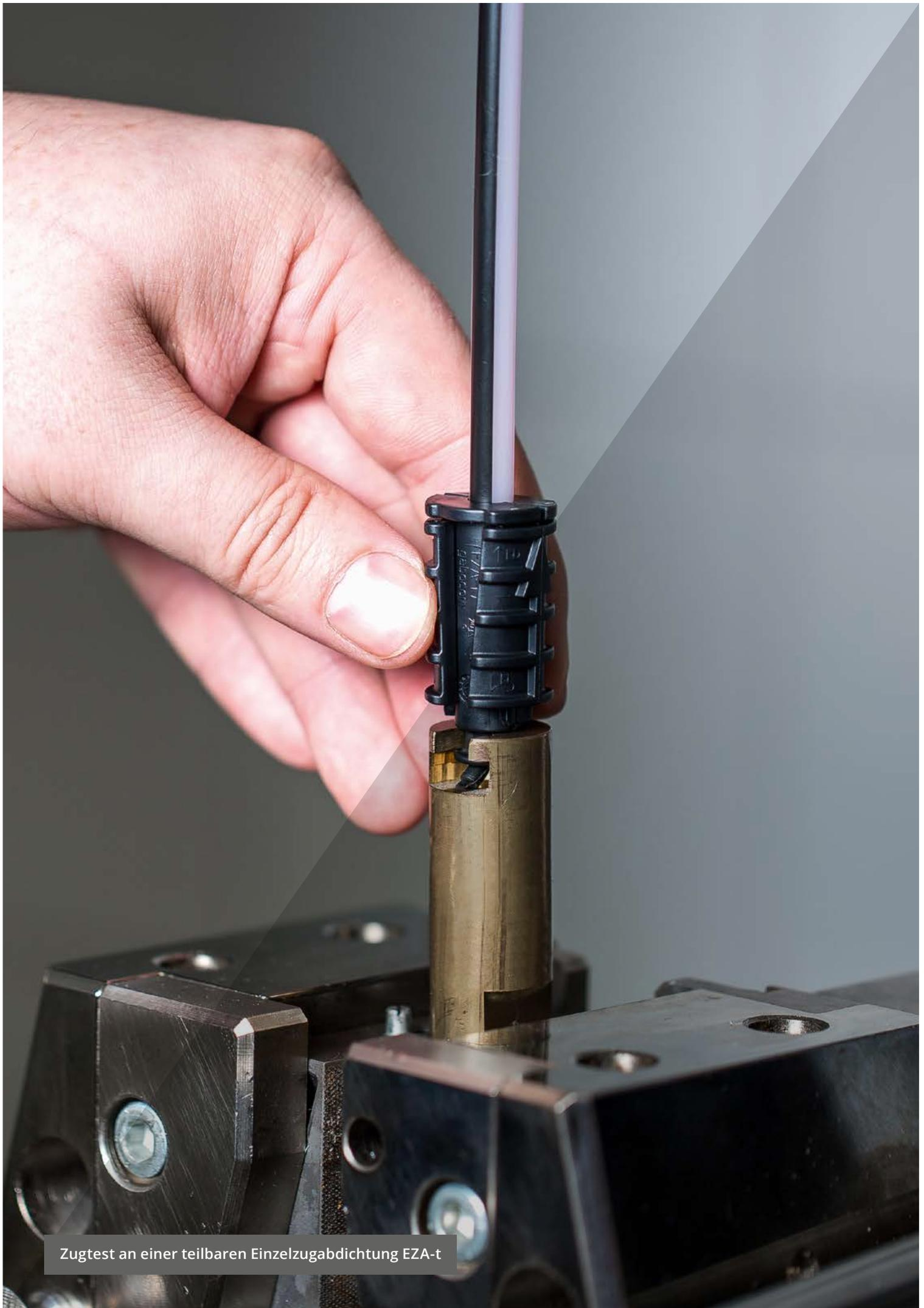
Zugtest an einer teilbaren Einzelzugabdichtung EZA-t
